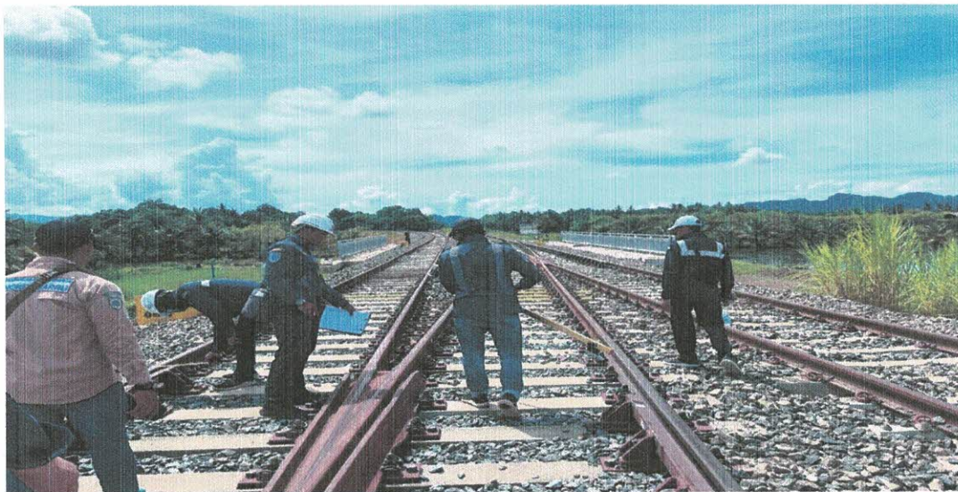
Kegiatan pengujian jalur dan bangunan oleh tim balai uji dibagi menjadi 2 tim, yaitu pengukuran emplacement dan wesel pada stasiun Labakkang, Ma'rang dan Mandalle
